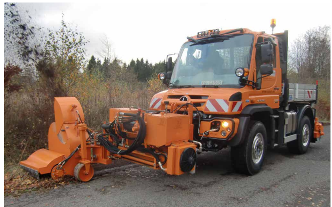
Der Unimog von AS Gerätebau mit leistungsstarker Randstreifenfräse BF 600
