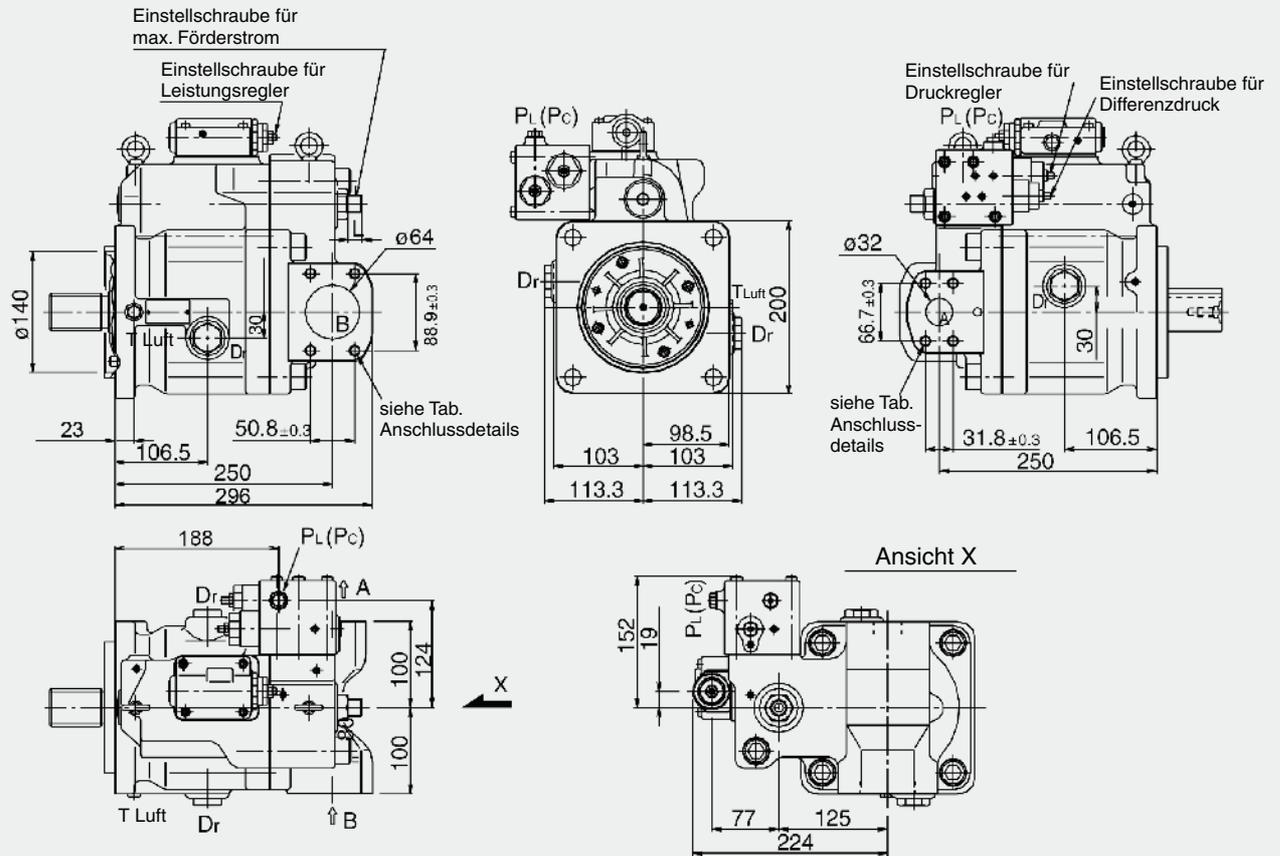
**Standard-Montageflansch (SAE D 4-Loch-Flansch) und Wellenvarianten**
