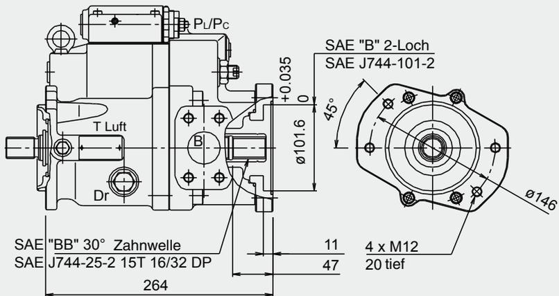
**K3VL - 80 mit Druckregler / Load-Sensing Regler und Modul für Leistungsregler
