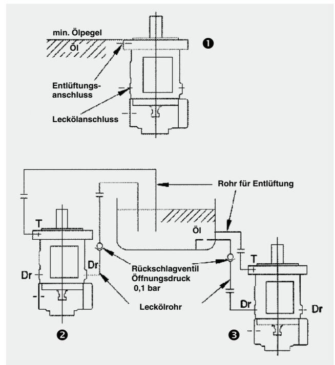
Ein Rückschlagventil mit einem Öffnungsdruck von 0,1 bar sollte, wie abgebildet, am Leckölanschluss des Gehäuses angebracht werden.
