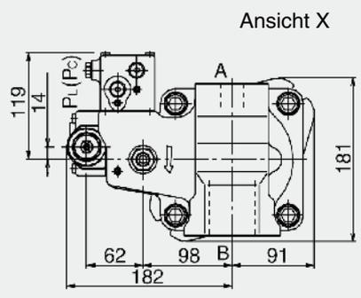
**Montageflansch und Wellenvarianten**
